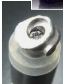
チタンブロックを削りだし、アバットメントを仕上げます。
