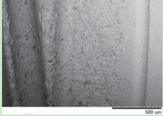
図2c マイクロスレッド部:2本のシングルマイクログループ下方・左側にマイクロスレッドが見られる。表面微細構造は、先端・左側に移行するに従い、次第にミディアムな構造となっている。
